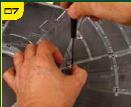
Зафиксируйте накладку с помощью крепежного винта.
