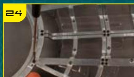
Зафиксируйте раму TF-28, закрутив винты в две соединительные наклейки с четырьмя отверстиями и кольцо турели.
