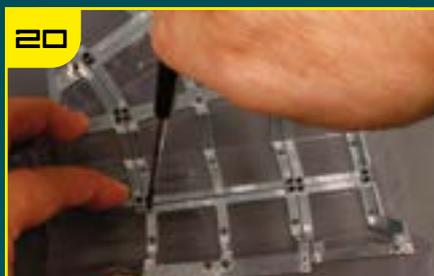
Зафиксируйте раму TF-26, закрутив винты в обе соединительные наклейки.
