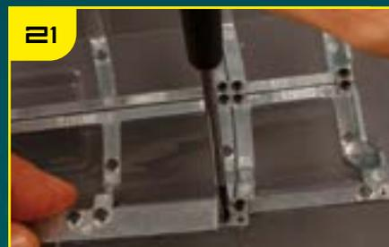
Зафиксируйте соединительную накладку с четырьмя отверстиями на стыке рам TF-23 и TF-26 с помощью трех винтов.
