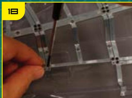
Зафиксируйте соединительную накладку с четырьмя отверстиями на стыке рам TF-25 и TF-27.
