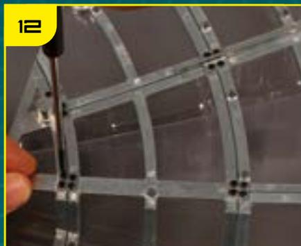
Закрутите винты во все четыре отверстия соединительной наклейки.
