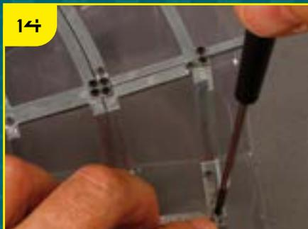
Зафиксируйте соединительную накладку с двумя отверстиями на внешнем ребре рамы TF-22.
