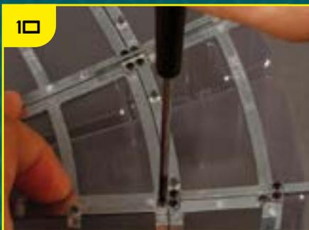
Зафиксируйте второй угол рамы TF-25, закрутив два винта в соединительную накладку с четырьмя отверстиями.
