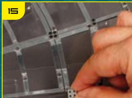
Зафиксируйте соединительную накладку с четырьмя отверстиями на стыке рам TF-22 и TF-25.
